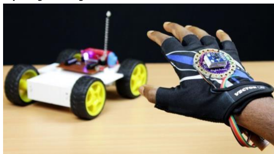
Slika 5: Upravljanje robota z roko
